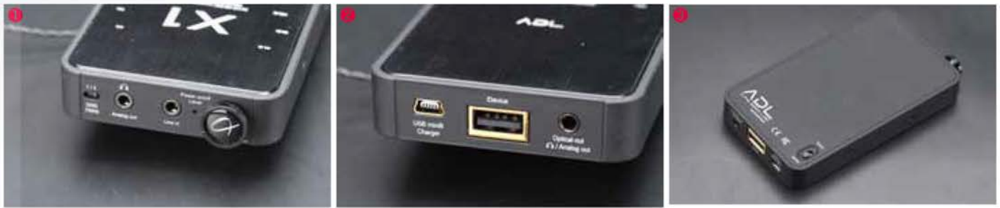
① 前面板由左至右分別為GND TRRS端子切換鍵、3.5mm耳機輸出、類比輸入，以及兼具開關功能的音量旋鈕。② 後方的介面有Mini USB、支援蘋果裝置的Type A USB與3.5mm數位光纖/類比輸出端子。③ 機身底部採用橡膠材質包覆，能夠有效保護機器避免磨損，角落處則設有USB DAC與Device切換功能鍵。
